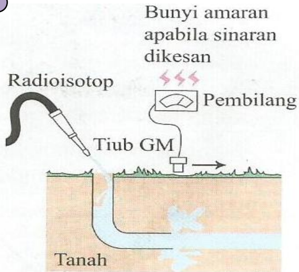
Rajah 6.10 Mengesan kebocoran paip bawah tanah
